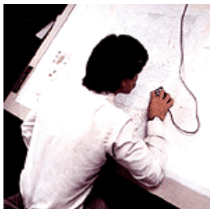
Σχήμα 2.7. Εισαγωγή Συντεταγμένων με τη βοήθεια χειροκίνητου ποντικιού
